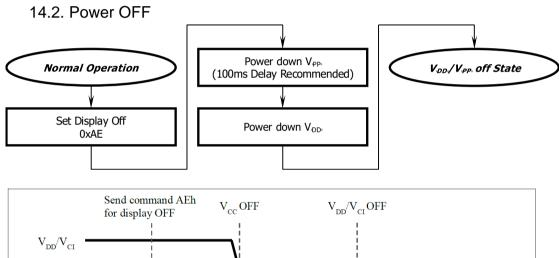
$V_{\rm DD}/V_{\rm CI}$  OFF  $V_{\rm CC}$  OFF
